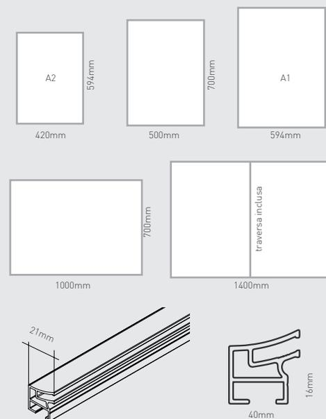
Cornice completa con profili in alluminio anodizzato color argento, angoli in metallo pressofuso color argento opaco.
