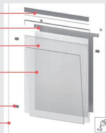
Materiale: La tasca Fly Shine è realizzata in plexiglass trasparente antiurto piegata a caldo e incisa a laser per migliorare la luminosità. Led compresi e già montati nella parte superiore della tasca.
