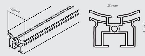
Cornice completa con profili in alluminio anodizzato color argento, angoli in metallo pressofuso color argento opaco.
